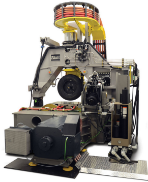
(a) Exemple d'une Flat-Trac pour des interactions roue/sol rigide développée par MTS
