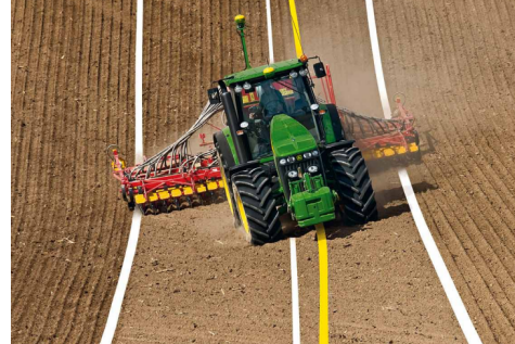
(a) Système TrueGuide passif qui contrôle le tracteur pour positionner l'outil (source : Vantage AM) (b) Décalage du tracteur pour positionner correctement l'outil (source : John Deere)
