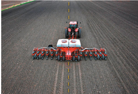
(a) Système TrueGuide passif qui contrôle le tracteur pour positionner l'outil (source : Vantage AM) (b) Décalage du tracteur pour positionner correctement l'outil (source : John Deere)
